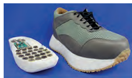
Figure 2 Prototype de la chaussure intelligente (à gauche semelle visible avec les modules de valves intégrées)
